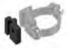
613C701-1 613C701-2 Extend:DDM-83 7.5mm (use M6x23 bolt) DDM-100 16.45mm (use MX32 bolt). Material:AL6061-T6
